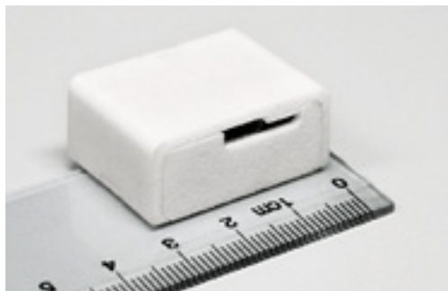
Sensormodulen som monteras i rökdykarens sko.
