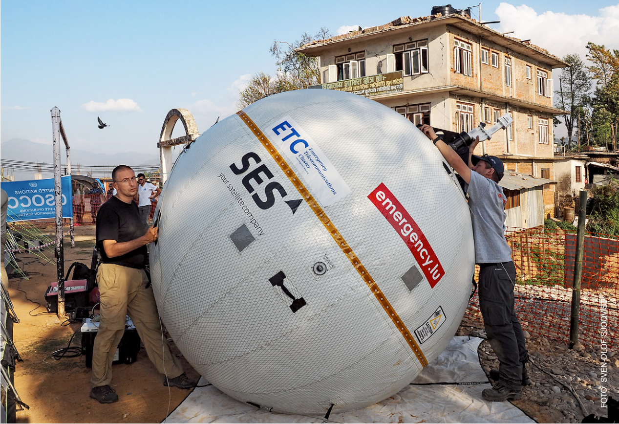
En uppblåsbar satellitantenn som kan packas i väskor och transporteras som vanligt bagage när man flyger. Antennen finns i beredskapslager hos MSB som också har utbildad personal för att sköta antennen.
