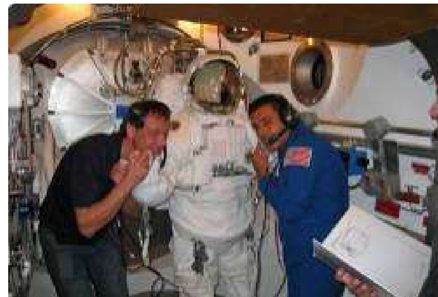
Det ser ut som om rymddräkten klappar oss på kinderna, men det vi gör är att känna om handsknarnas elvärme fungerar.
