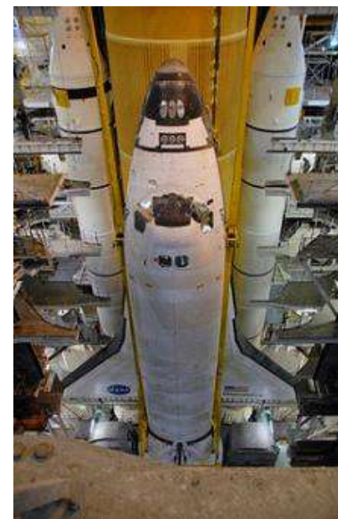
Discovery monteras ihop med bränsletanken och sidoraketer- na.
