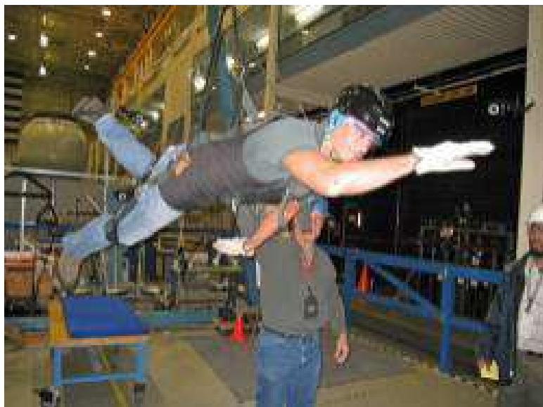
Danny visar sina talanger i tyngdlöshetssträning med POGO, en lyftanordning som ger oss möjlighet att träna på reaktionskrafter när inte jorden under fötterna kan hjälpa till. Den används speciellt för bultdragaren (PGT) och olika kopplingar (el, vätskor).
