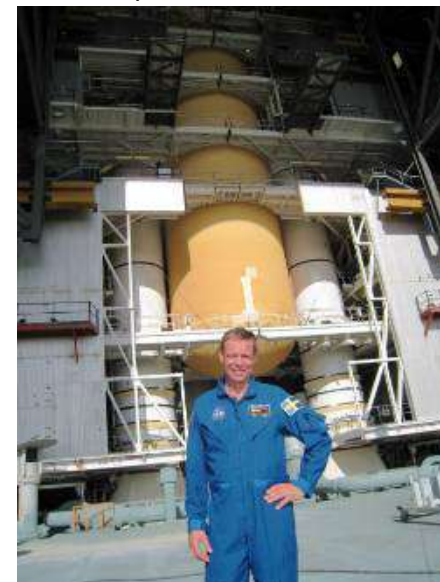
Bakom mig nedre delen och botten av den extra tanken, mellan de två fastbränsleraketerna som ger den mesta kraften de två första minuterna under uppskjutningen.
