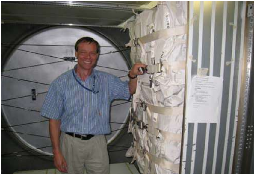
Inne i MPLM-träningsmodellen med en rack full med typiska packväskor för saker som ska till ISS. Totalt får 16 sådana här rack plats i MPLM:en, fyra längs varje sida (där "tak" och "golv" ingår). En del rack är fullt utrustade, med t.ex. stora experimentuppsättningar och förs över helt och hållet till ISS där alla moduler på den icke-ryska sidan använder samma racksystem.
