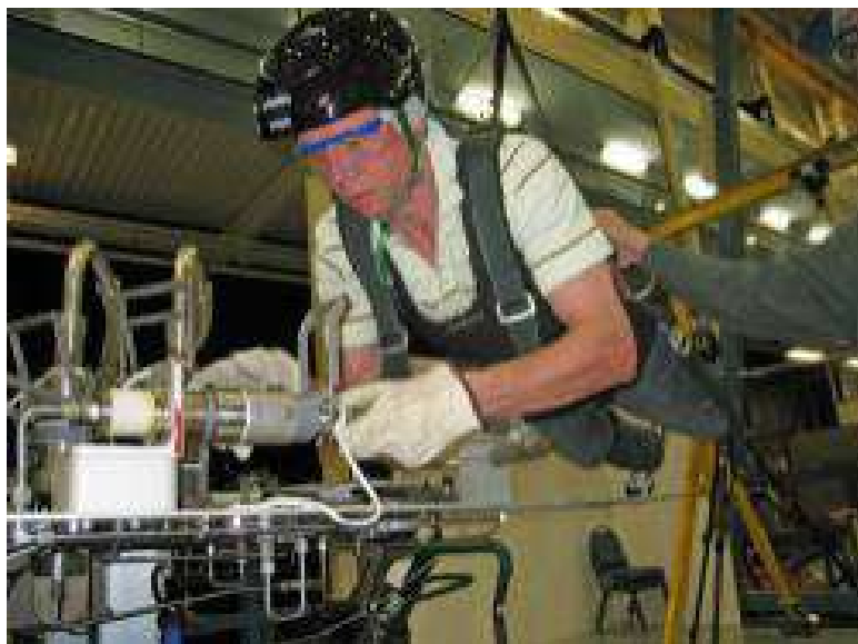
Jag kopplar ihop en vätskeledning medan jag hänger i sele som gör att jag får en känsla för vilka reaktionskrafter som behövs. När vi byter ut ammoniaktanken (ATA) under rymdprovenad ett och två måste vi jobba med dessa kopplingar.
