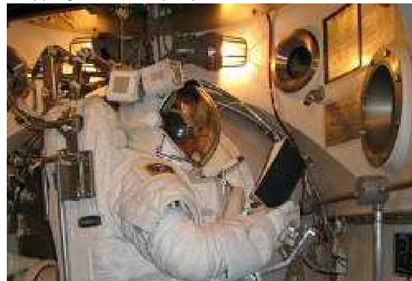
Innan man kan gå ner i tryck (rymddräkten håller 1/3 atmosfär när omgivningen är i vakuum) måste kroppen rensas på kvävgas. Det görs här under fyra timmars syrgasandning. Då kan det vara bra att ha något att läsa under tiden.
