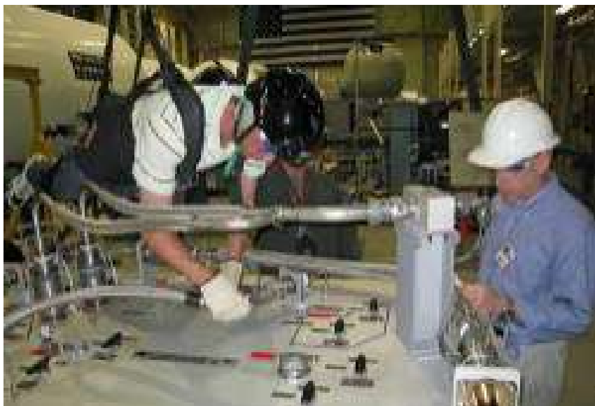
Jag kopplar ihop en vätskeledning medan Pat läser instruktionerna. När vi byter ut ammoniaktanken (ATA) under rymdpromenad ett och två måste vi jobba med dessa kopplingar.
